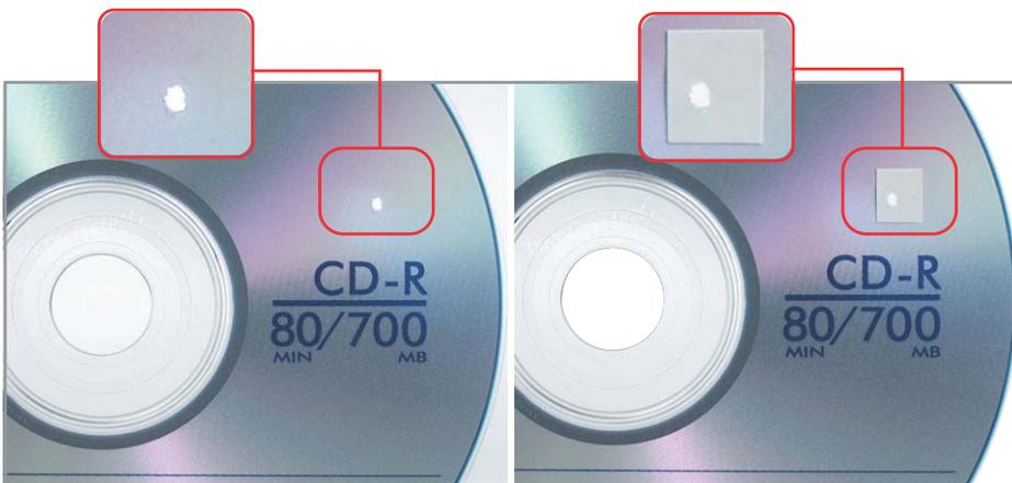
▲ Накладываем пластырь: если протертое место заклеить бумагой, которая более-менее в состоянии отражать падающий на нее свет, то данные с неповрежденных областей можно спасти
