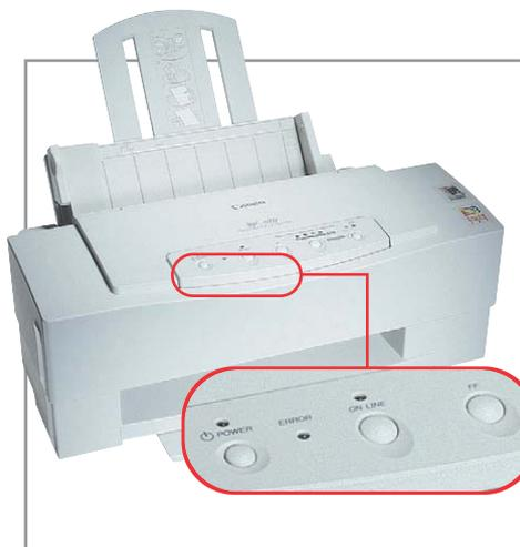
▲ «Ловкость рук» и никакой магии: при включении вилки силового кабеля в сеть держите эти три кнопки одновременно нажатыми, и ваш принтер «забудет» о проработанных часах
